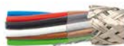
HELUKABEL® HELUDATA® TRONIC-CY 2464 / 300 GREY AWM STYLE 2464 22 AWG / 0,34 QMM 12 C 83291 80°C 300V VW-1 AWM I/II A/B 80°C 300V FT1
